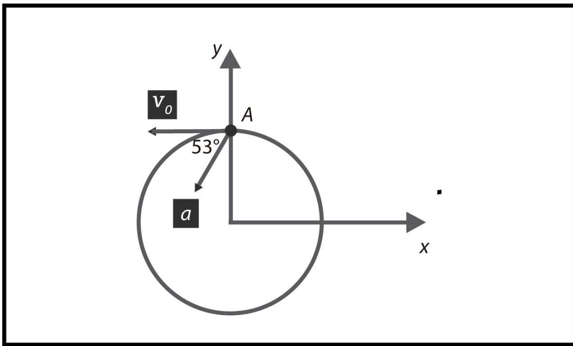
Una partícula se mueve sobre una circunferencia de radio  $2,0 \text{ [m]}$  en sentido antihorario con rapidez uniformemente creciente. En  $t = 0$  pasa por el punto A de la figura con una velocidad angular  $\omega_o=4k \text{ [rad/s]}$  y su aceleración forma un ángulo de  $53^\circ$  con la velocidad. Determine: a) las componentes normal y tangencial de la aceleración en  $t = 0$ ; b) el tiempo que demora la partícula en pasar de nuevo por A (por primera vez).
