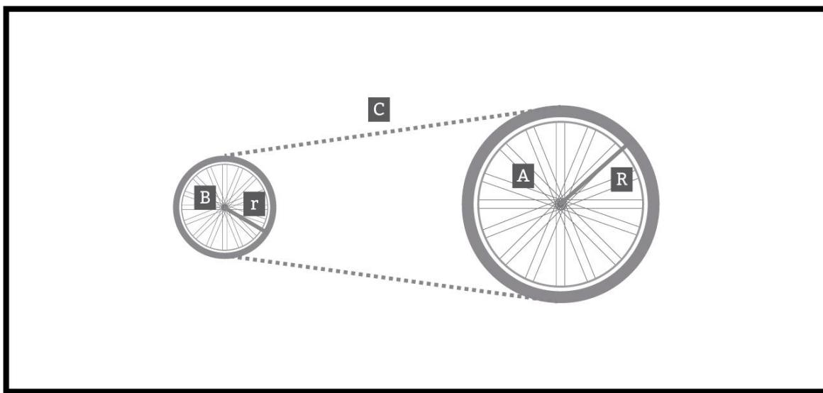
La rueda A, cuyo radio es de 30 [cm], parte del reposo y aumenta su velocidad angular uniformemente a razón de  $0,4\pi$  [ $\text{rad/s}^2$ ]. La rueda transmite su movimiento a la rueda B, de 12 [cm] de radio, mediante la correa C. Obtenga una relación entre las aceleraciones angulares y los radios de las dos ruedas. Encuentre el tiempo necesario para que la rueda B alcance una velocidad angular de 300 [rpm].
