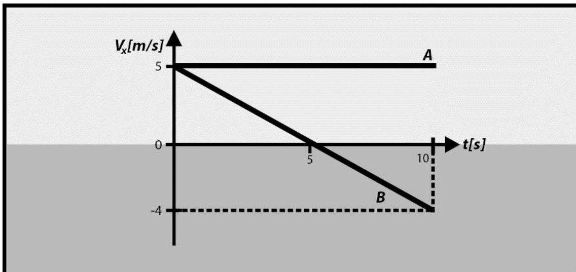
Dos partículas, **A** y **B**, se mueven sobre el eje  $x$  por pistas paralelas. En el gráfico adjunto se muestra velocidad v/s tiempo para cada partícula. Determine:
