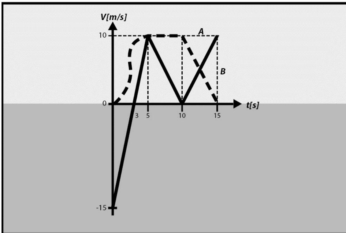
Dos partículas, **A** y **B**, se mueven sobre el eje x por pistas paralelas. En el gráfico adjunto se muestra velocidad v/s tiempo para cada partícula.
