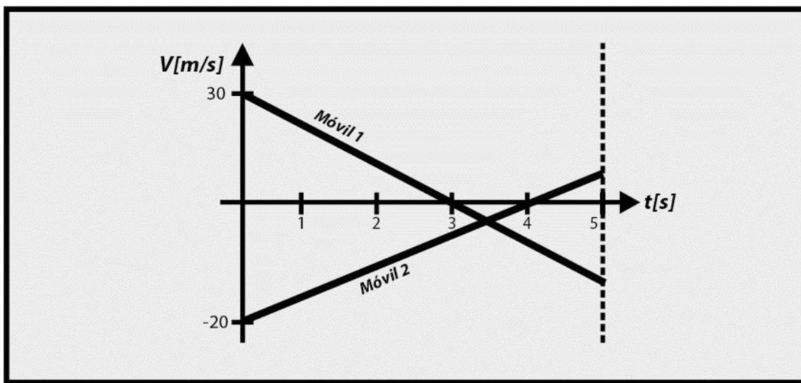
Dos móviles 1 y 2 se mueven a lo largo de una recta (eje x) durante 5 segundos, de acuerdo al gráfico v v/s t adjunto. Si para  $t=0$ ,  $x_{01}=-40$  [m] y  $x_{02}=20$  [m] encontrar:
