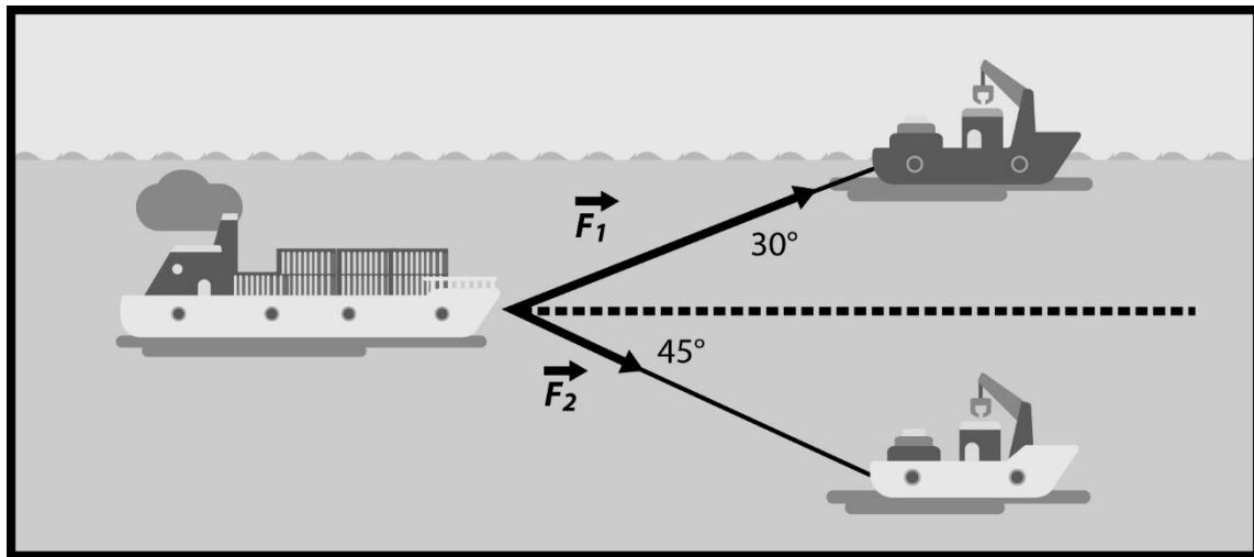
Dos remolcadores arrastran una barcaza, por agua tranquila. Uno tira con una fuerza  $F_1 = 20[\text{kN}]$  con un ángulo de  $30^\circ$  respecto del eje de la barcaza, como se muestra en la figura. El segundo remolcador jala con una fuerza  $F_2 = 15[\text{kN}]$  y un ángulo y un ángulo de  $45^\circ$  también respecto del eje del barco. Determine:
